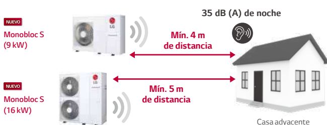
El nivel de la presión acústica* varía según la distancia de la ODU
