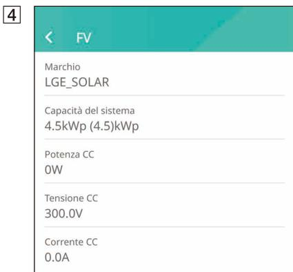
Visualizza brevemente lo stato di generazione del FV connesso. I valori di stato sono la somma di FV1, FV2
