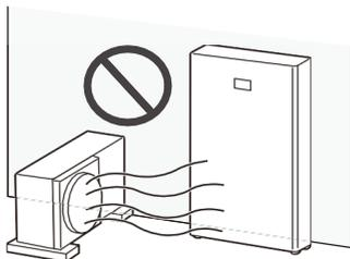
Quando instalar o produto junto a uma unidade exterior de ar condicionado, instale o produto numa posição que evite qualquer ar quente expelido pela unidade exterior de ar condicionado.
