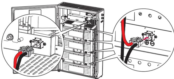
9 Den Kommunikationskabelstrang anschließen - siehe Abbildung.
