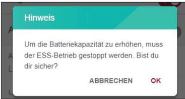
Eine Popup-Meldung wird angezeigt. Auf [OK] tippen, um den ESS-Betrieb anzuhalten und um zum nächsten Schritt überzugehen.
