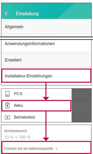
Auf [Installateur-Einstellungen] > [Akku] > [Erhöhen Sie die Batteriekapazität] tippen.
