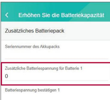
Messen Sie die Spannung des zusätzlichen Batteriemoduls und geben Sie unter [Zusätzliche Batteriespannung für Batterie 1 oder 2] die entsprechenden Werte ein, und tippen Sie auf [SPEICHERN].
