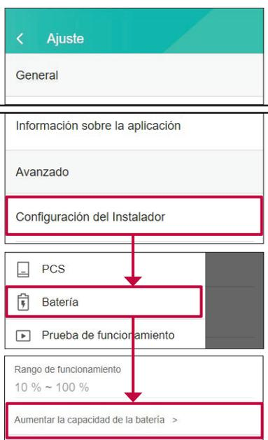
Pulse [Configuración del instalador] > [Batería] > [Aumentar la capacidad de la batería].
