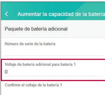
Mida la tensión del módulo de batería adicional, introduzca el valor en el campo [Voltaje de batería adicional para batería 1 o 2] y pulse [GUARDE].
